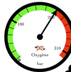
Manomètre indiquant la pression dans la bouteille d'oxygène. (Pression de stockage d'une bouteille 200 bar)
