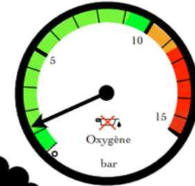
Manomètre indiquant la pression d'utilisation de l'oxygène. (Pression d'utilisation 1.2 bar)
