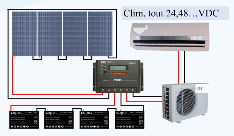
Système 100% DC, le régulateur sert à garantir une tension DC constante pour alimenter le climatiseur
